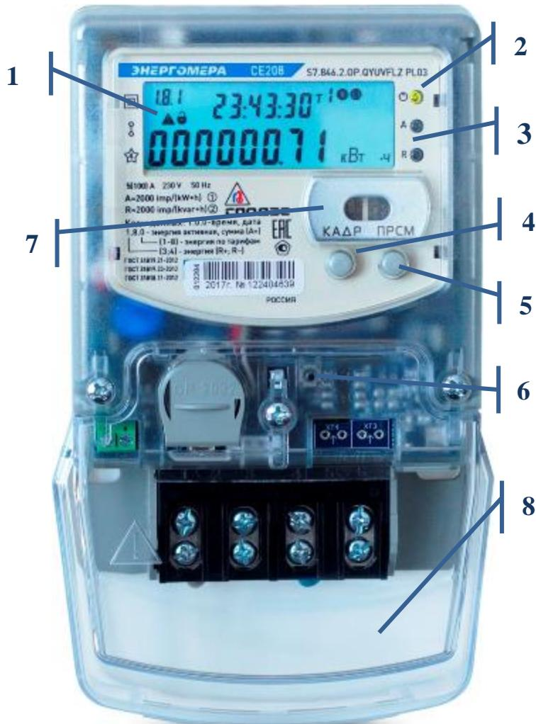
Рисунок 7 – Внешний вид счетчика СЕ208 S7
