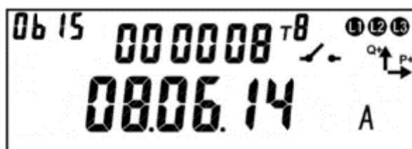
Рисунок 223 – Окно события «пломба опломбирована».
