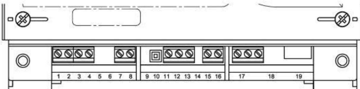
обозначение контактов счетчика СЕ308 S31, S34
