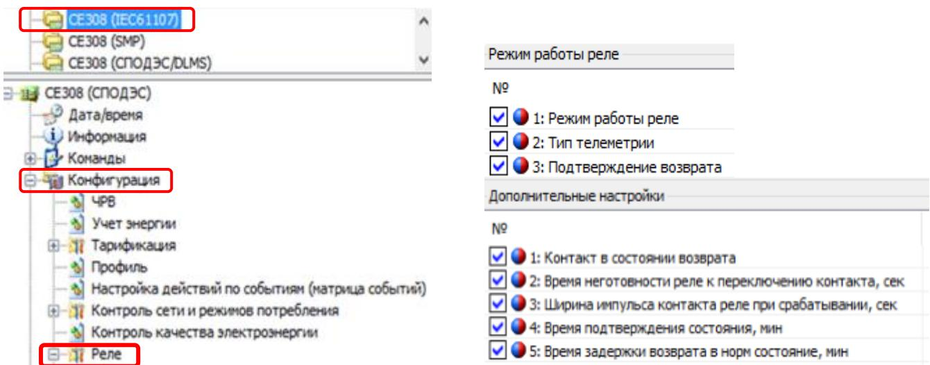
Рисунок 177 – Путь к настройкам и режимы работы реле.
