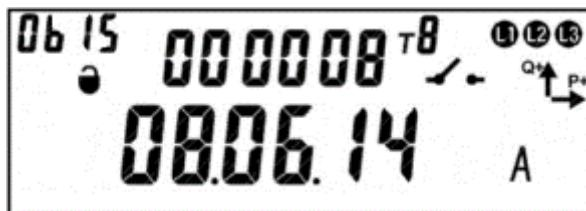
Рисунок 227 – Окно события «повторное вскрытие пломбы».
