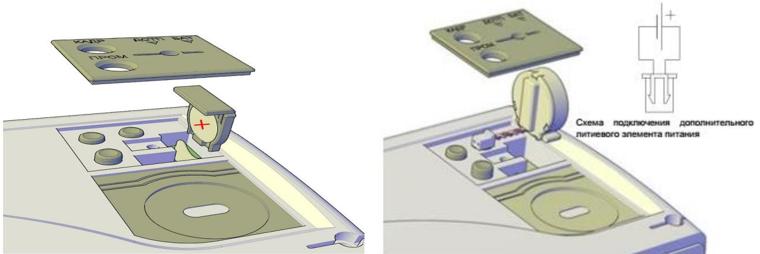
а) Установка дополнительного литиевого элемента питания в счетчике СЕ 308 SX с держателем.
