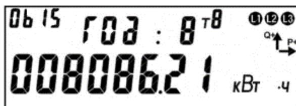
Рисунок 113 – Энергия зафиксированная на конец года (за год).
