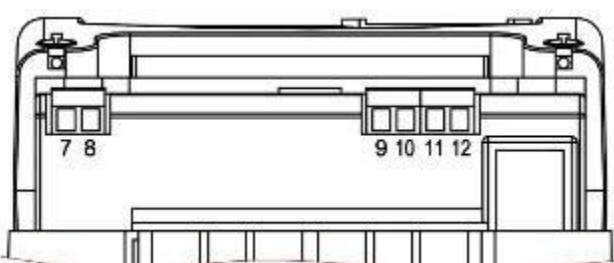
б) обозначение контактов счетчика с интерфейсом ЕІА-485
