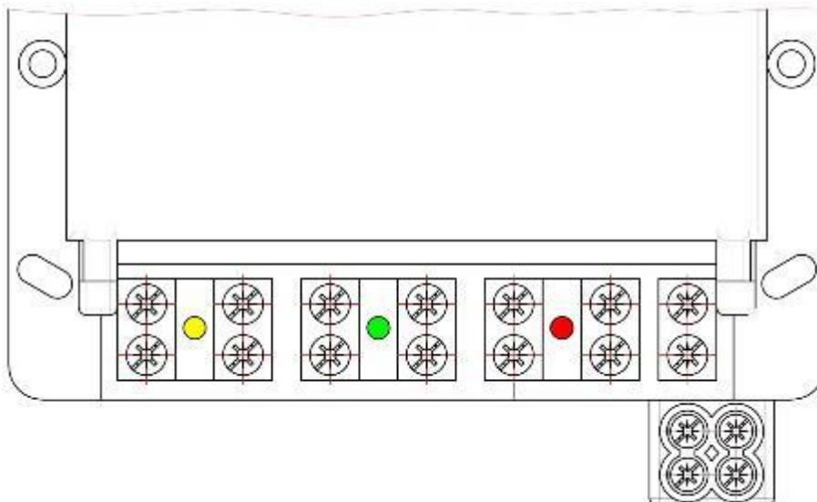
д) – обозначение контактов зажимов счетчика СЕ308 S34 с переходником для подключения второго нулевого контакта<sup>12</sup>
