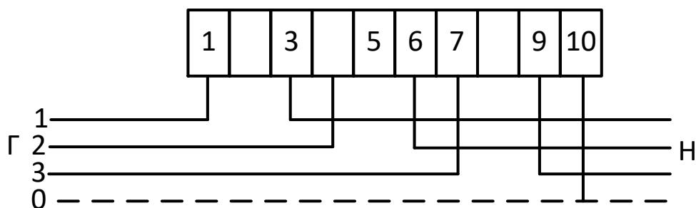
в) Схема подключения счетчика СЕ308 S31.745 (230В, 5(60)А),
