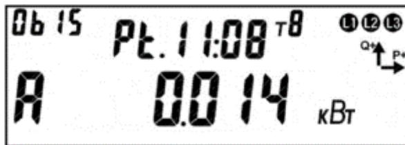
Рисунок 143 – Окно состояния контроля мощности.
