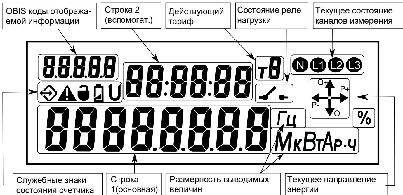
Рисунок 10 – Вид ЖКИ счетчика.
