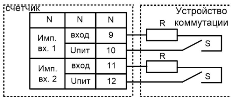
Рисунок 19 – Подключение импульсных входов
