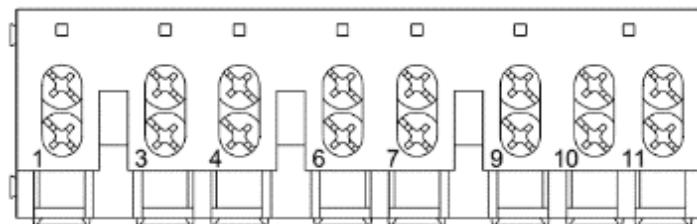
б) - обозначение контактов зажимов счетчика СЕ308 S31.745
