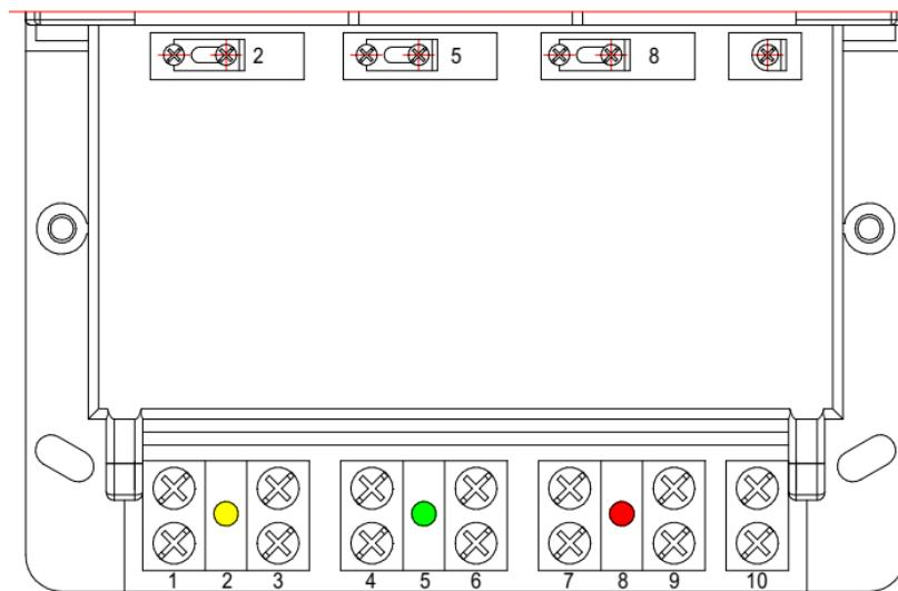
г) – обозначение контактов зажимов счетчика СЕ308 S34<sup>11</sup>
