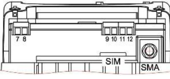
д) обозначение контактов счетчика с GSM модулем
