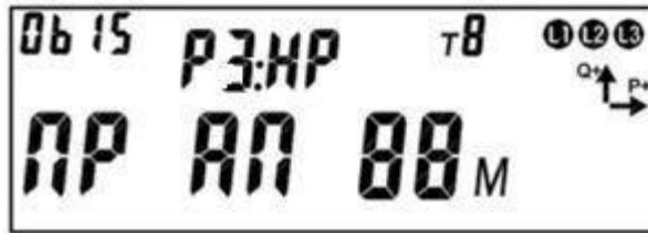
Рисунок 197 – Окно настроек реле сигнализации и РУН.
