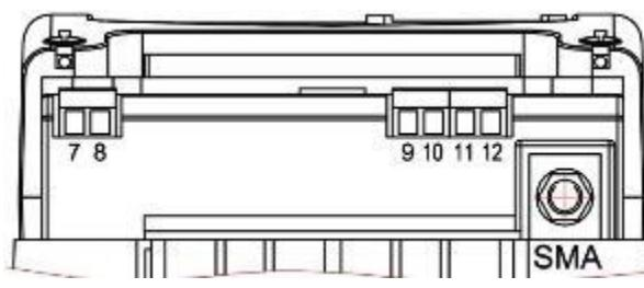
в) обозначение контактов счетчика с радиомодулями, с внешней антенной
