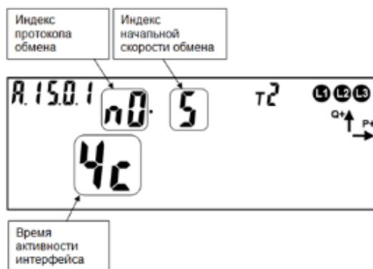
Рисунок 26 – Настройки оптического интерфейса связи с протоколом «Авто»
