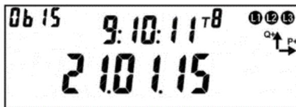
Рисунок 124 – Дата-время начала провала напряжения.
