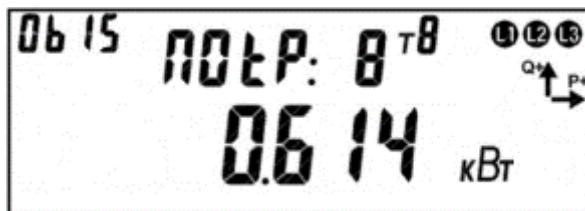
Рисунок 149 – Окно с зафиксированным максимумом мощности.
