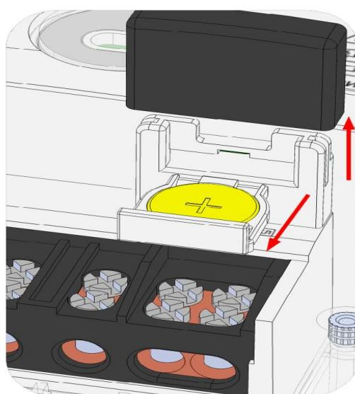
в) Установка дополнительного литиевого элемента питания в счетчике СЕ 308 C36.
