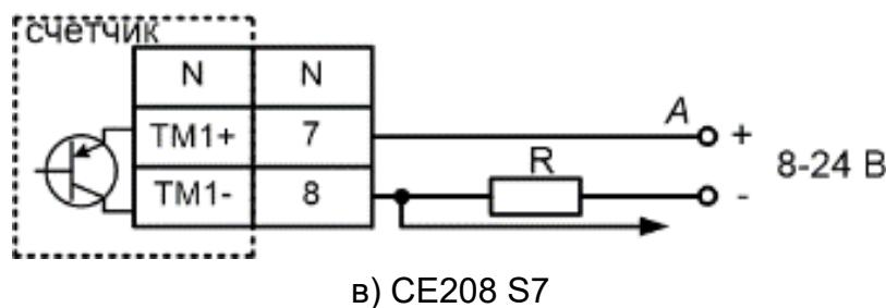
Рисунок 18 – Схема подключения импульсных выходов счетчика
