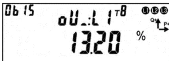
Рисунок 129 – Отклонение напряжения.
