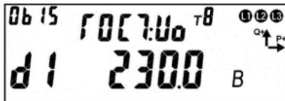
Рисунок 121 – Значение опорного напряжения и день недели начала интервала контроля.
