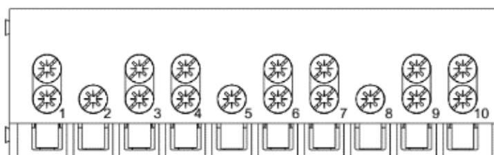
а) - обозначение контактов зажимов счетчика СЕ308 S31.5Х3
