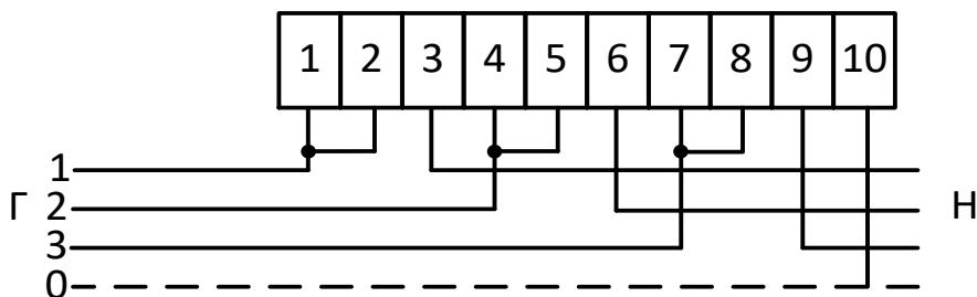
г) Схема подключения счетчика
