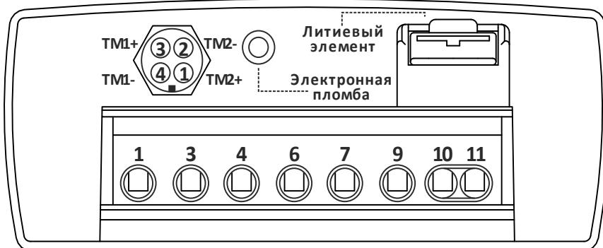
контакты 3, 4 разъема – подключение импульсных выходов ТМ1;
