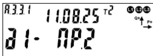
Рисунок 97 – Исключительный по тарификации день с фиксированной датой.
