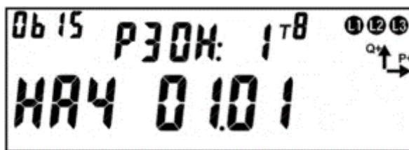
Рисунок 139 – Дата начала действия расписания контроля мощности.
