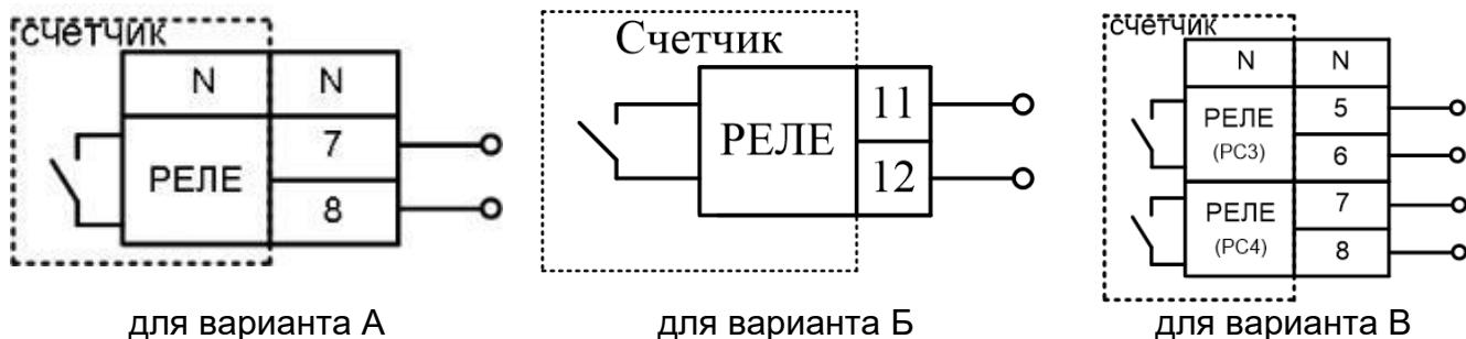
Рисунок 20 – Схема подключения реле сигнализации счетчика СЕ308 S31 в зависимости от варианта см. рисунок 14
