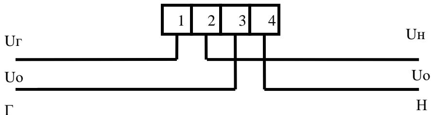
Рисунок 13 – Схема подключения СЕ208 XX
