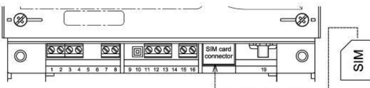
обозначение контактов счетчика СЕ308 S31, S34 для исполнений со встроенным
