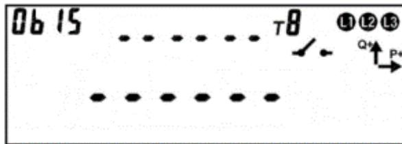
Рисунок 226 – Окно с незафиксированной электронной пломбой на вскрытие.
