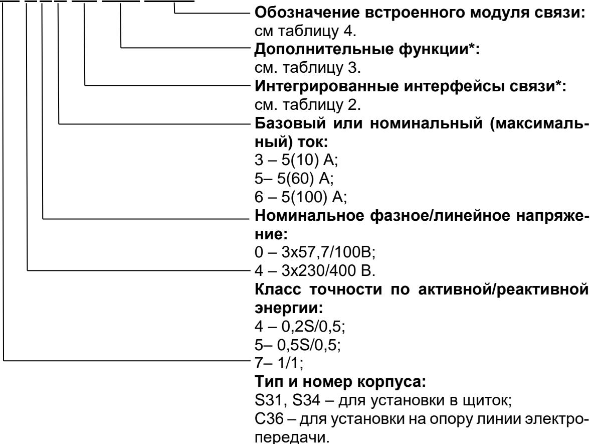
Рисунок 2 – Структура условного обозначения СЕ308
