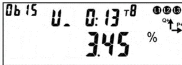
Рисунок 123 – Длительность провала напряжения и глубина провала.
