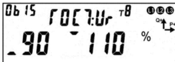
Рисунок 122 – Границы контроля напряжения.
