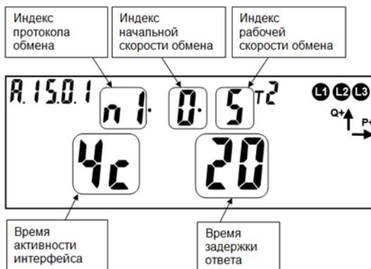
Рисунок 27 – Настройка оптического интерфейса связи по протоколу ГОСТ ИЕС 61107-2011 (проприетарная реализация)
